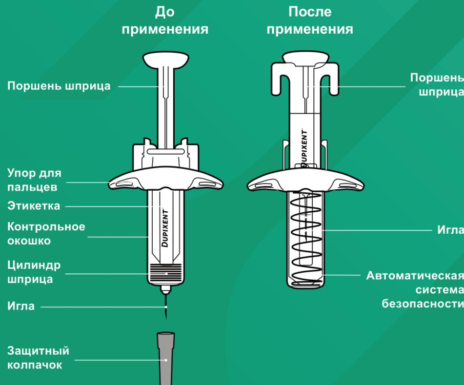
Во избежание случайного травмирования иглой каждый готовый шприц оснащен автоматической системой безопасности, которая активируется автоматически после выполнения инъекции, изолируя иглу.
